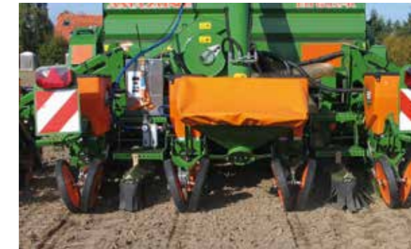
Nur Sägeräte mit spezieller Technik zur Minderung der Staubabdrift dürfen bestimmtes behandeltes Saatgut ausbringen.
