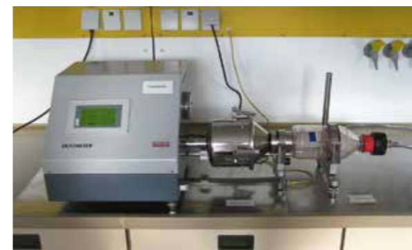
Dustmeter mit Filterkörper: Mit diesem Gerät kann der Staubabrieb („Heubachwert“) ermittelt werden.
