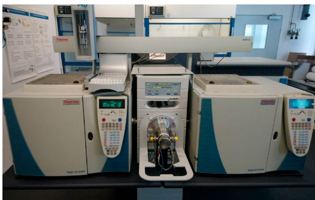
Abb. 3.13 Messgerät zur Bestimmung von Dioxinen (Gaschromatografie gekoppelt mit hochauflösender Massenspektrometrie mittels Sektorfeld-MS) (Quelle: LLBB)
