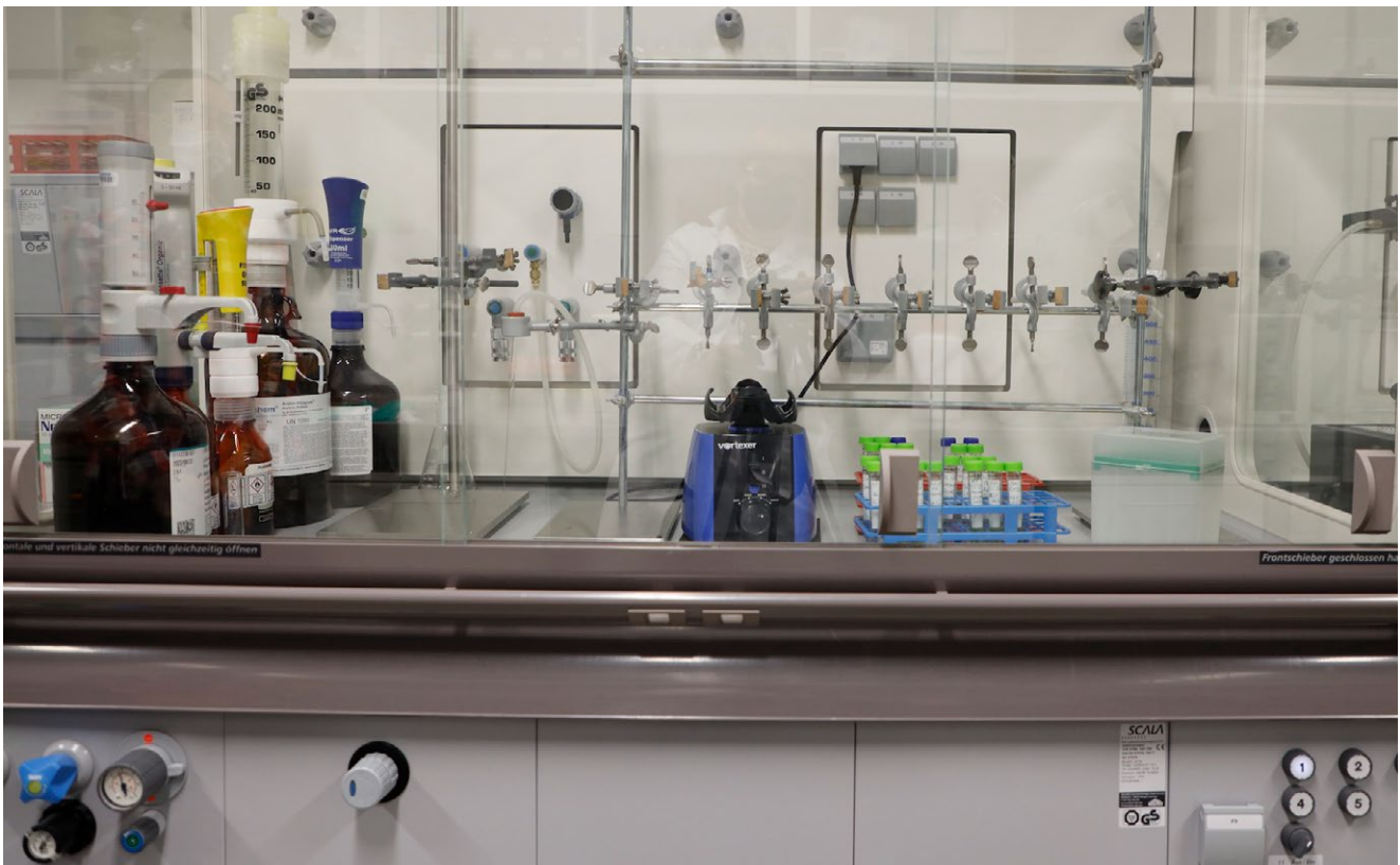
Abb. 2.1 Laborabzug, links: Lösungsmittelflaschen mit Dispensette (Flaschenaufsatz zum Dosieren von Lösungsmitteln), Mitte: Vortexer (Schüttelmaschine), rechts: Zentrifugenröhrchen (Quelle: LLBB)
