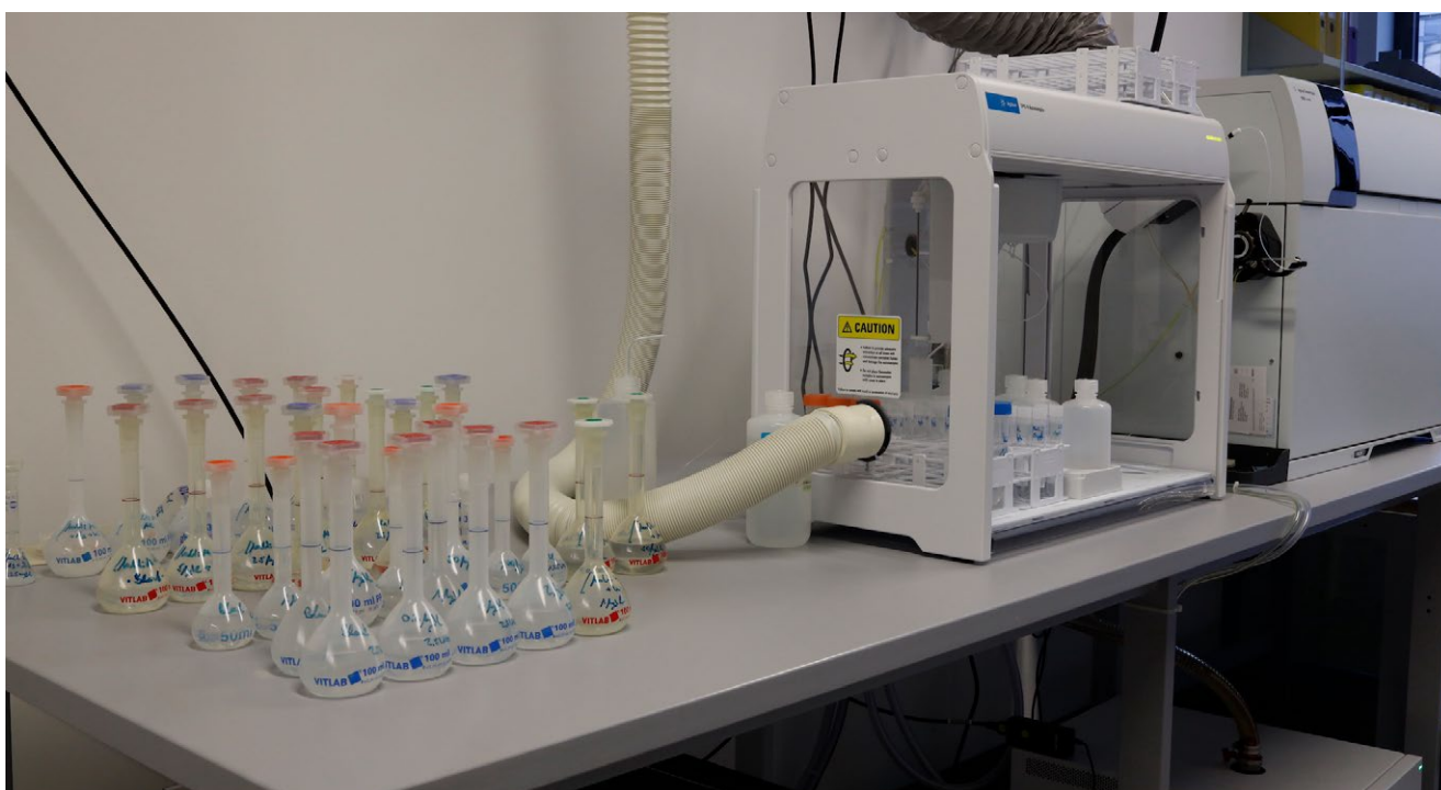
Abb. 3.17 ICP-MS Massenspektrometrie mit induktiv gekoppeltem Plasma, Bestimmung von Elementen u.a. zur Spurenanalyse von Schwermetallen (Quelle: LLBB)
