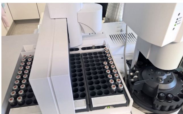
Abb. 3.3 Autosampler der GC-MS/MS mit Probenvials für Pestizid-Untersuchung (Quelle: LLBB)
